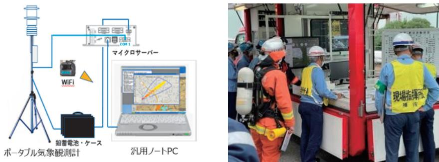
図16 ポータブル気象観測計、影響評価システム（ALOHA）、および地理情報システム（QGIS）の連携による化学物質拡散に係るリアルタイム影響範囲の可視化システム（左）とこれを用いた消防機関及び民間企業の協力に基づく検証（右）<sup>20</sup>
