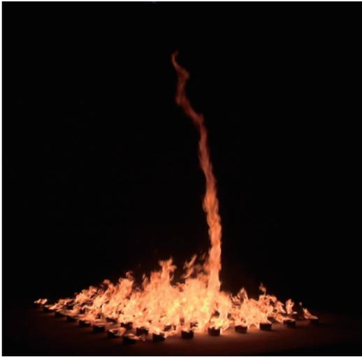
写真1 火柱状の火災旋風の実験写真
