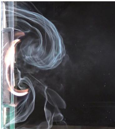
写真3 火源風下に発生する火災旋風を煙で可視化した写真
