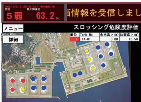
図12 スロッシング・バルジング評価システムによる結果出力の例 (大保、私信)
