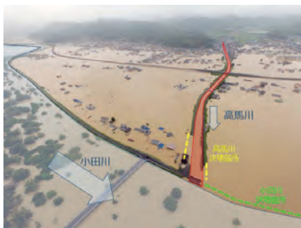
写真1 決壊した小田川と高馬川の状況及び水流方向
