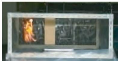
⑤火炎が通過した後、薄い紙は燃えている。段ボール紙は端面がわずかに焦げただけである。工事用養生シートと工事用養生シート(難燃)は、熔融する。
