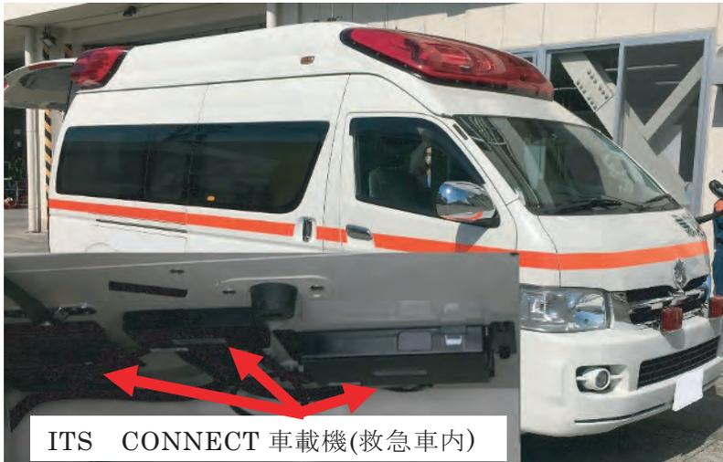
写真6 ITS CONNECT 搭載救急車
