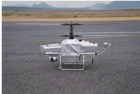
写真1 飛行型偵察・監視ロボット一次試作機の概観
