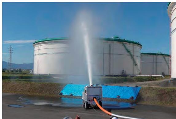
写真6 石油コンビナートにおける試験評価（放水）
