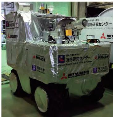
写真3 放水砲口ロボット一次試作機の概観
