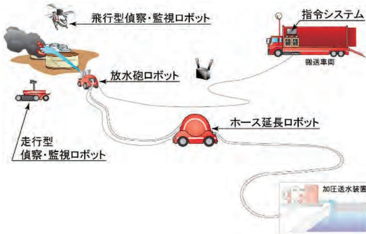
図1 消防ロボットシステムの活動イメージ
