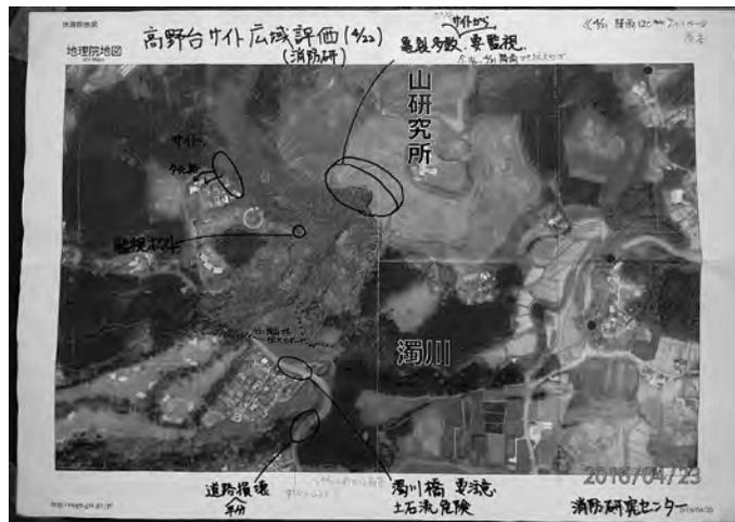
図1 熊本地震による高野台の搜索救助活動現場における危険性評価結果
