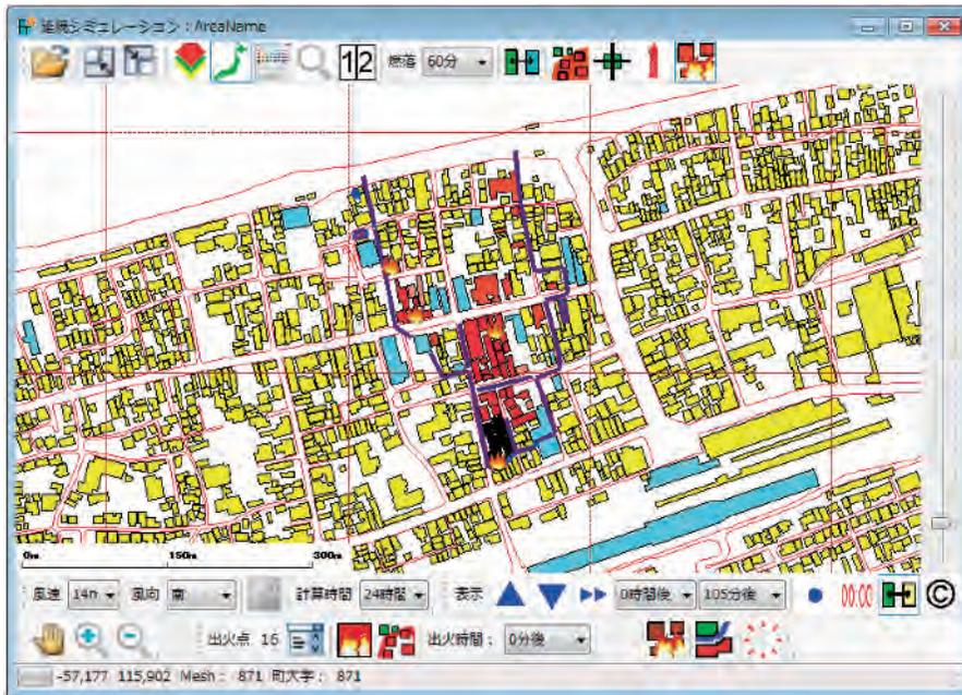
図4 市街地火災延焼シミュレーションの画面例
