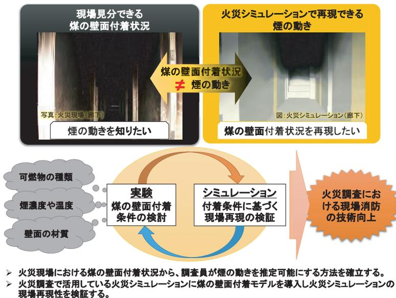
図4 煤の壁面付着状況の観察に基づく煙の動きの推定の概要
