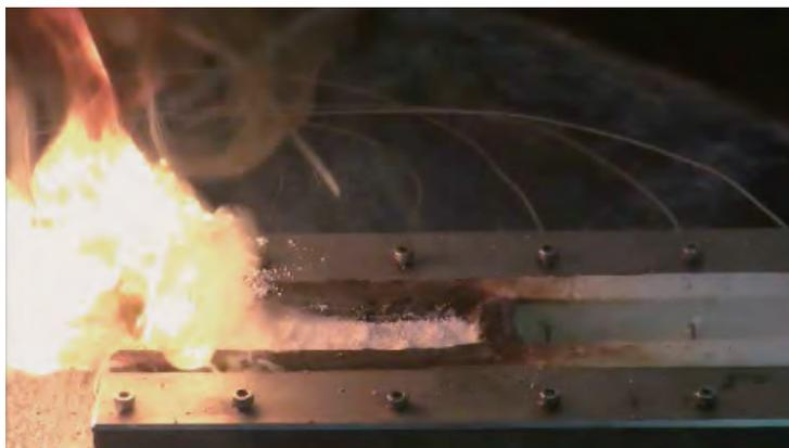
図4 燃焼速度測定装置における過酸化ブチルの燃焼の様子
