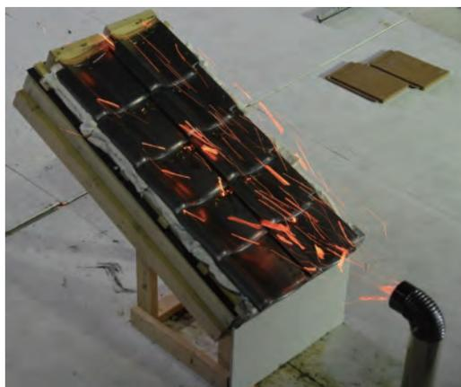
図6 日本瓦を対象とした中規模実験の様子
