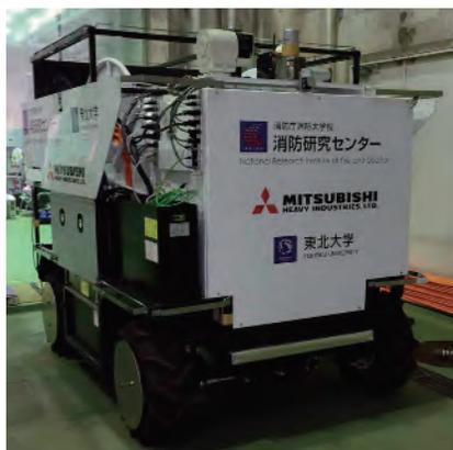
写真4 ホース延長ロボット一次試作機の概観
