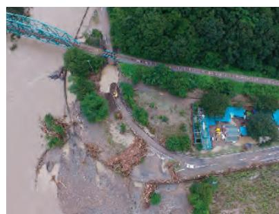
写真7 道路流出、陥没の状況
