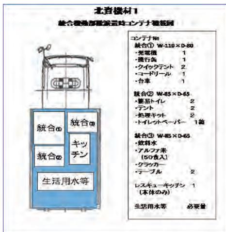
図1 コンテナ積載図
