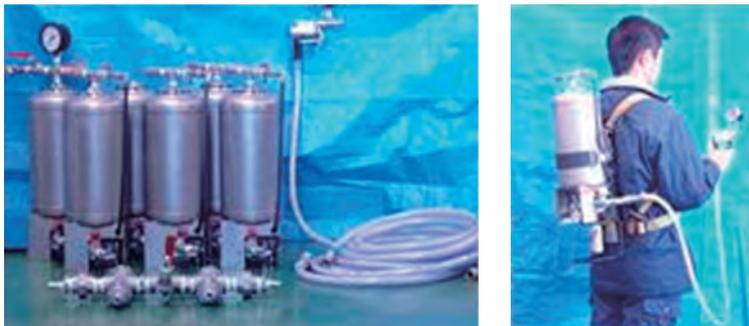
図5 試作遮光剤噴射装置（左:地上置き、右:背負い）
