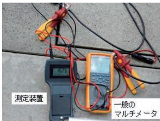
図3 発電を抑制できたかを確認するための測定装置の例
