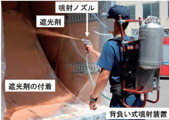
図1 背負い式の遮光剤噴射装置の試用の様子
