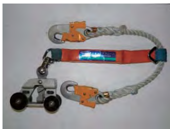
写真3 昇降器具（ラビット）
