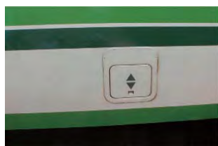
写真2：車外の集中用ドアコック
