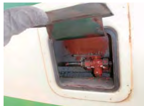
写真3：集中用ドアコック開放時
