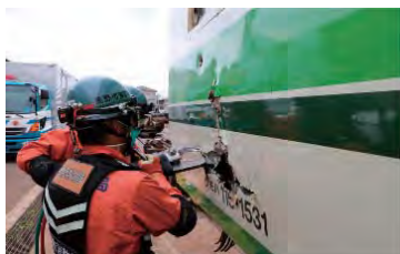
写真7：油圧救助器具による切断
