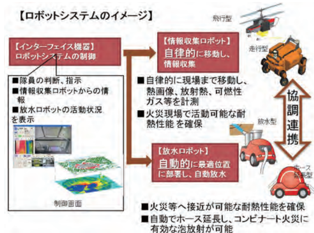
図3 開発中の災害対応のための消防ロボットの全体イメージ
